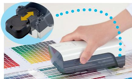
La céramique de calibration peut être rangée sous l'appareil lors des mesures.
