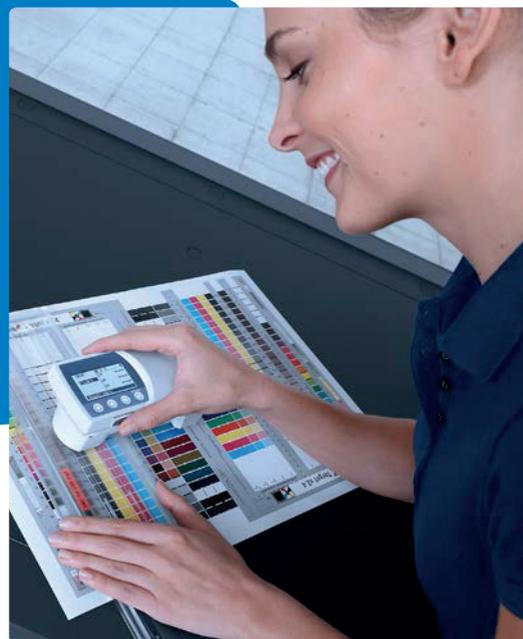
Equippé des dernières technologies optiques de Konica Minolta, **le FD-5BT offre non seulement une précision exceptionnelle** mais aussi des mesures en mode M1 (D50) au plus proche de la perception des couleurs par l'œil humain, permettant de réduire les erreurs liées à la couleur dans le flux de production, réduisant de ce fait les erreurs d'impression.
