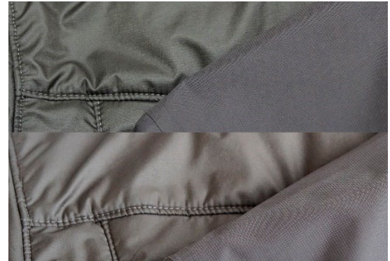
Die gleichen zwei Stoffe, aber unter verschiedenen Lichtquellen. Der linke Stoff wechselt von grün zu braun.
