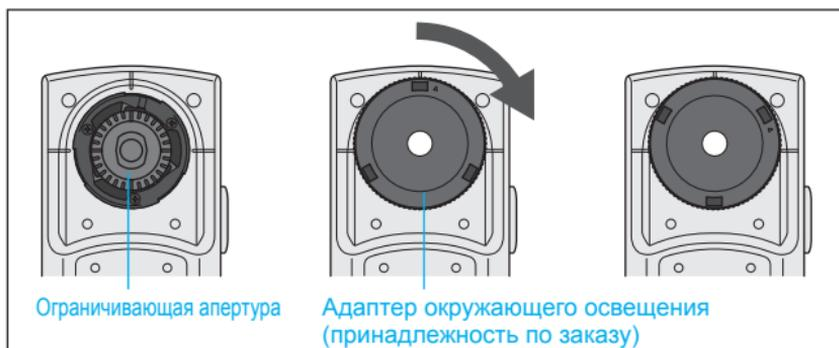
**ВНИМАНИЕ!** Запишите заранее значение адаптера окружающего освещения в память прибора с помощью средства настройки спектрофотометра MY-ST1. Средство настройки спектрофотометра MY-ST1 можно загрузить на веб-сайте. (<https://www.myiro.com/downloads>)
